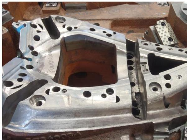
Al mecanizar la cajera para el alojamiento del elevador se detectan rechupes. Si en el modelo esta cajera se hubiera realizado no hubieran aparecido el defecto.
