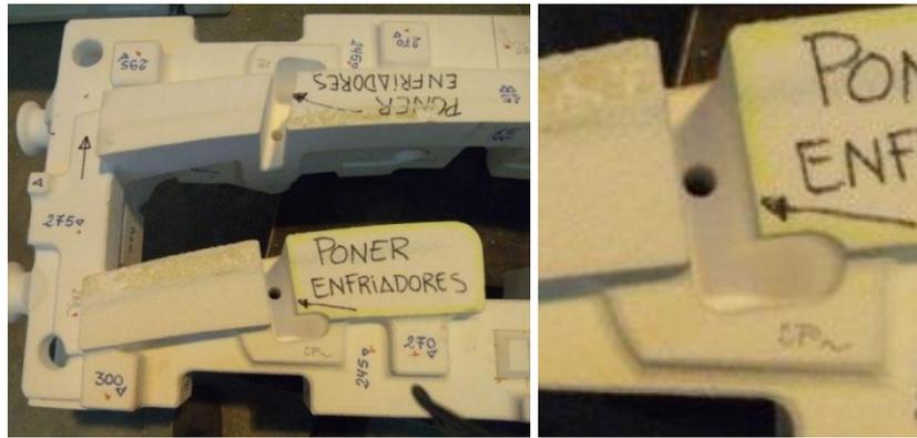
El modelo dispone de los alojamientos de para los elevadores, así como de los agujeros para paso y guiado de los cilindros de elevación.
