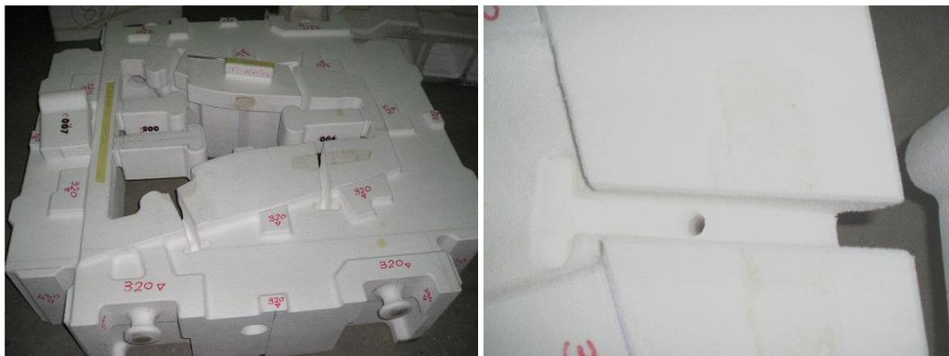
Deseamos que la información recogida en este manual sea aclaratoria y evite la aparición de rechupes. En el caso de que en el diseño o en el modelo no realicen las recomendaciones anteriormente indicadas, es muy difícil que en la fundición lo detectemos ya que desconocemos en que zona va a llevar este tipo de vaciados o si lo van a llevar y de no aplicarse, seguirán saliendo rechupes.
