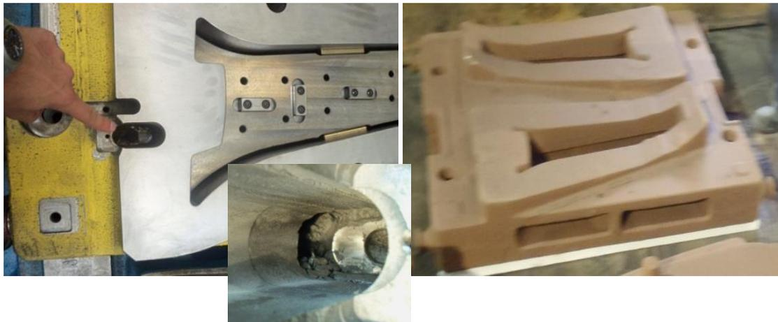
En el modelo no estaban realizados los librados para los detectores de chapa ni para los centradores.
