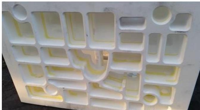
El encintado debe realizarse sobre todas las uniones que tenga el modelo tanto exteriormente como interiormente ya que es la única forma de evitar la separación de las uniones o encoladuras. Para ello, se recomienda la utilización de cintas adhesivas, con buena adherencia, que aguanten la humedad y que tengan elasticidad.
