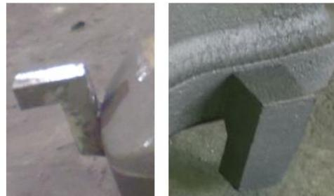
En ningún caso deben sobresalir en exceso ya que no se garantiza su integridad en el proceso de la fundición, haciendo imposible la manipulación segura de las piezas.
